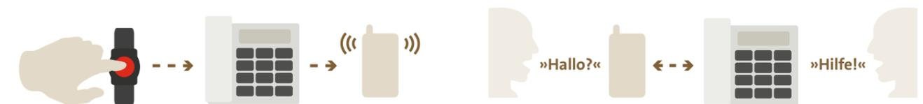
1. Per Knopfdruck am Armbandsender Alarm auslösen. Alarmempfang durch Notruftelefon und automatische Weiterleitung zum Zieltelefon
